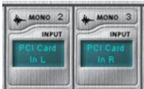
1. アナログライン入力のシグナルを録音する場合、PatchMix DSP ミキサーのミキサーストリップフィールドに「PCI Card In L」および「PCI Card In R」ストリップが存在することを確認します。これらのストリップが作成されていない状態では、アナログライン入力に接続された機器からのシグナルは E-MU 0404 には入力されませんので、「New Strip (ストリップの作成)」ボタンを押し、表示されるダイアログボックスから「Physical Source」を選択して新たに「PCI Card In L」および「PCI Card In R」ストリップを作成します。
