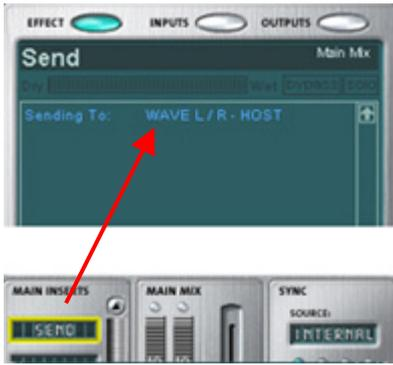
4. 録音にはバンドルアプリケーションの WaveLab Lite を使用します。PatchMix DSP ミキサーからのシグナルを WaveLab Lite で録音するためには、PatchMix DSP ミキサーに「HOST WAVE L/R」のセンドオブジェクトが挿入されている必要があります。一番分かりやすく簡単な設定としては、メインセクションにあるメインインサートセクションで右クリックし、表示される左図のポップアップメニューから、「Inserts Send (Output to ASIO/Wave or Physical Out)」を選択し、リストから「HOST WAVE L/R」を選択します。
